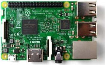
Fig. 2. Raspberry Pi 3 Model B
